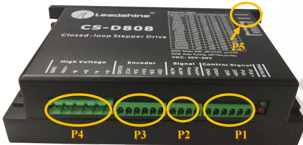
Figure 2: CS-D808 / CS-D1008 connectors
