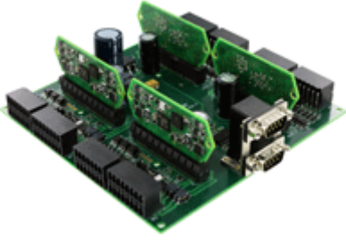
Lexium-Motion-Modul2.jpg: Entwicklungsboard mit vier Modulen
