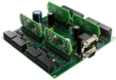
Lexium-Motion-Modul2.jpg: Entwicklungsboard mit vier Modulen
